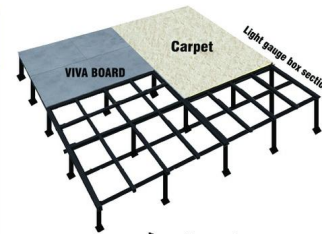
พื้นยกมีวัสดุปิดทับ
