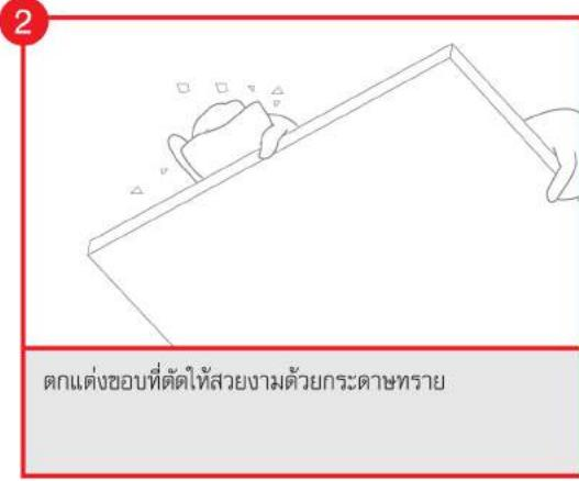
การตัดด้วยคัตเตอร์ : หมายสำหรับแผ่น สมาร์ทบอร์ด เอสซีจี ความหนา ตั้งแต่ 3.5 และ 4 มม.
