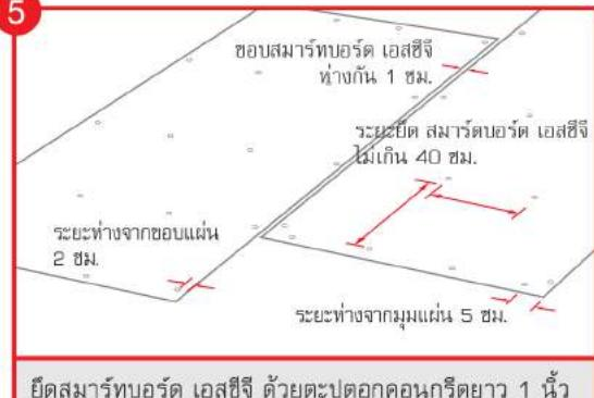
ปิดスマาร์ทบอร์ด เอสซีจี ด้วยตะปูคอกคอนกรีตยาว 1 นิ้ว ตามจุดที่กำหนดไว้ และให้ขอบสมาร์ทบอร์ดห่างกันประมาณ 1 ซม. โดยติดตั้งแบบลับแผ่น
