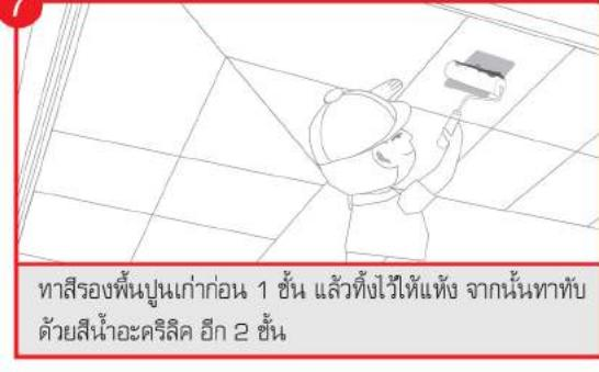
หากต้องพื้นบูรณะก่อน 1 ชั้น แล้วติดไว้ให้แน่น จากนั้นทาทับด้วยสีน้ำอะคริลิก อีก 2 ชั้น
