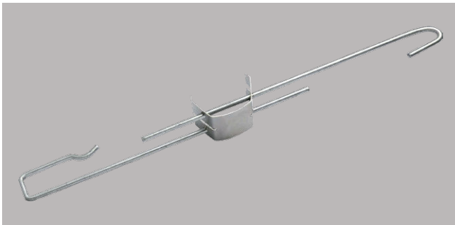
2 ประกอบชุดปรับระดับก่อนล่างกับลวดแขวนก่อนบนที่เหมาะสมกับระยะเหนือฝ้า และปรับให้ทุกตัวยาวเท่ากัน ก่อนนำขึ้นไปแขวน ข้อควรระวัง เพื่อความปลอดภัยควรเลือกใช้ข้อล๊อคโครงและลวดแขวนก่อนบนที่มีเส้นผ่าศูนย์กลาง 4 มม. เท่ากัน ของตราช้าง
